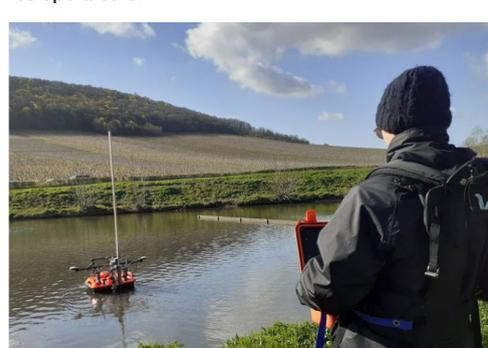
↳ Drone aquatique en cours de mesure dans un bassin de lagunage
